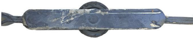
Abbildung 1: Im Betrieb verschmutztes Kettenglied vor der Reinigung
