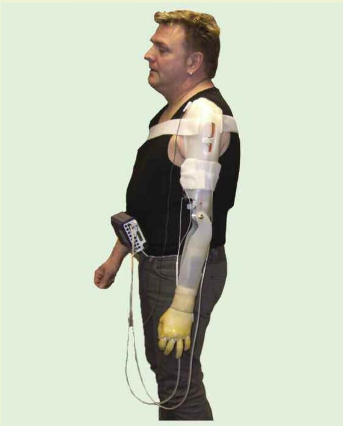
Abb. 4: Amputierter Proband während einer Testreihe mit dem Prototypen einer neuartigen Oberarmprothese.
