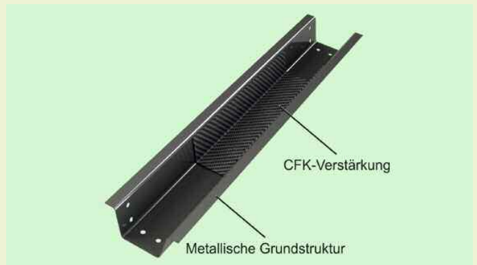
Abb. 9: Hutprofilstruktur als Abstraktion eines automobilen Strukturbauteils in Hybridbauweise: eine höchstfeste metallische Grundstruktur mit einer lokalen Verstärkung aus einem Faserverbundkunststoff wie CFK.
