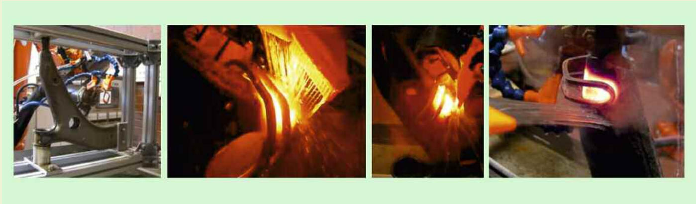
Abb. 4: Partielle induktive Härtung eines Querlenkers: Der Induktor erwärmt die Struktur in definierten Bereichen. Durch das anschließende Abschrecken wird der Werkstoff gehärtet.
