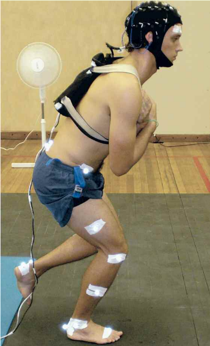
Abb. 5: Aufzeichnung kinetischer, kinematischer und elektrophysiologischer Daten während einer einbeinigen Kniebeuge.
